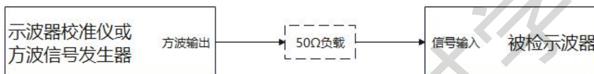
图1 直流增益的校准连接框图（方波法）
