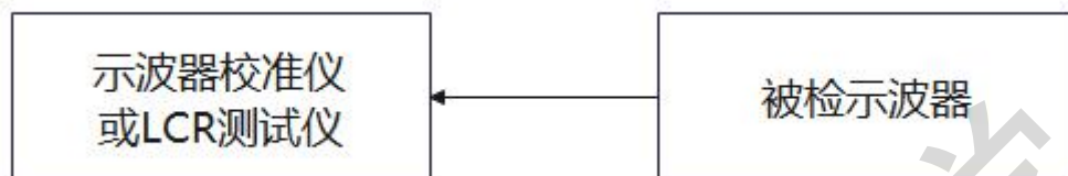
图 20 输入电容的校准连接框图
