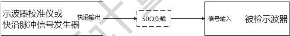
图 5 上升时间/过冲的校准连接框图
