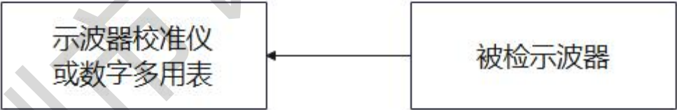
图 16 输入电阻的校准连接框图
