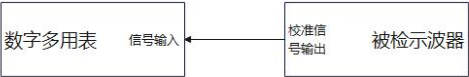
图 15 方波/直流校准信号幅度的校准连接框图
