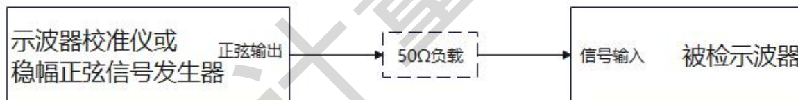
图 3 频带宽度校准连接框图
